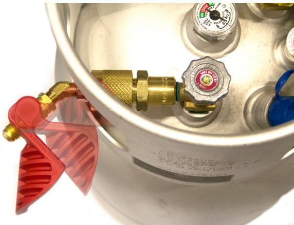
Protéjase y proteja a sus técnicos de lesiones causadas por un sello roto en la válvula del cilindro de GLP. Si el sello falla, la válvula de seguridad cierra el flujo de gas en el acoplador para evitar fugas peligrosas. Además, el diseño de la manija de la válvula cubre el acoplador de modo que el operador no lo puede desconectar mientras la válvula este en la posición abierta.
